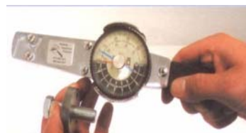
图 10 检查作用在环规上的扭矩值
