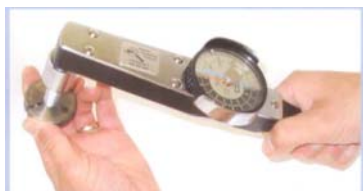
图 9 用扭力扳手施加环规上检验损伤的螺纹
